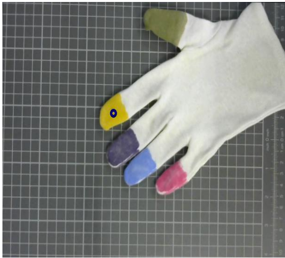
Imagen 34a: Detección del centro de gravedad del dedo índice visto en imagen RGB.
