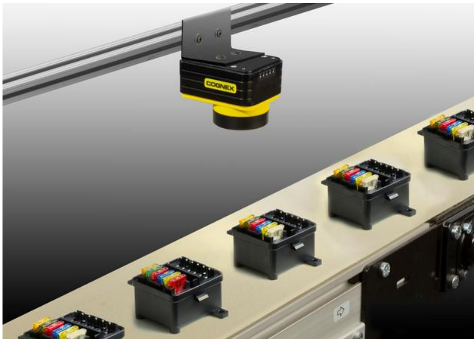
Imagen 7: Control de calidad en una línea de producción por medio de un sistema de visión artificial.
