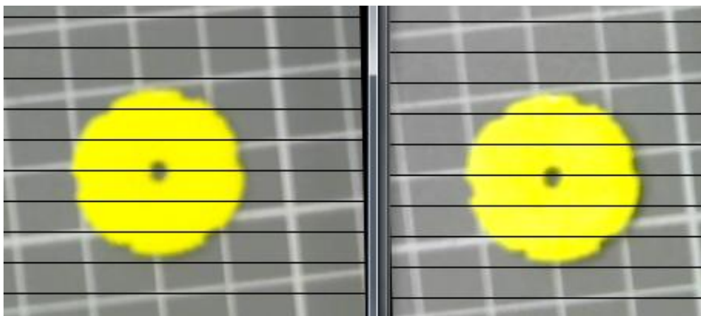
Imagen 22: El centro de la ficha de referencia permite una mejor comprobación de la coincidencia entre líneas epipolares.
