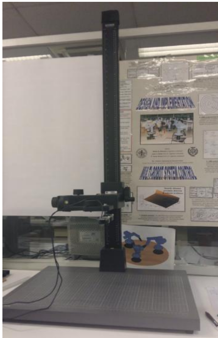
Imagen 14: Soporte de sujeción para las cámaras con cuadrícula incorporada.
