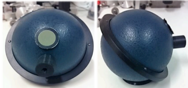
Imagen 9 y 10. Esfera integradora de Ulbricht. La luz entra por un orificio, se refleja multitud de veces y sale uniformada por el otro orificio.
