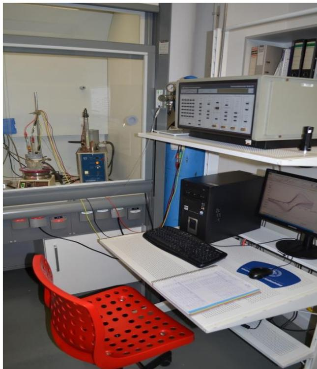
Ordenador conectado mediante tarjeta GPIB que permite el control del potencióstato y el tratamiento de los datos mediante los siguientes programas :
