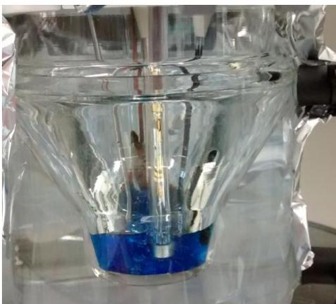
La celda electroquímica utilizada ha sido una celda Metrohm 6.1415.150 de vidrio Pirex. Su capacidad es de 25,0 ml y consta de dos partes bien diferenciadas:
