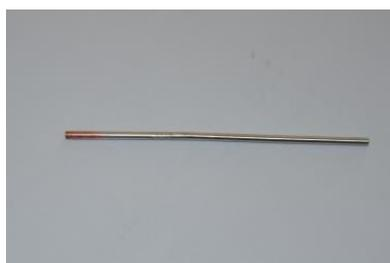
Figura 19.- Electrodo de Pt recubierto de cobre
