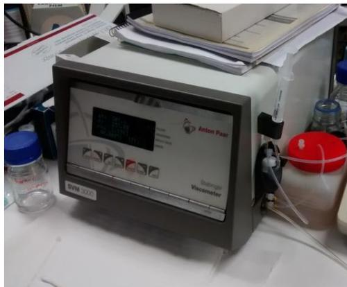
En la muestra, que se encuentra llenando ese tubo, flota el rotor de medición con un imán integrado. Debido a la baja densidad del rotor, este se mantiene centrado mediante la fuerza centrífuga. El rotor flotando libremente no requiere ningún rodamiento, y por tanto, no hay fricción.
