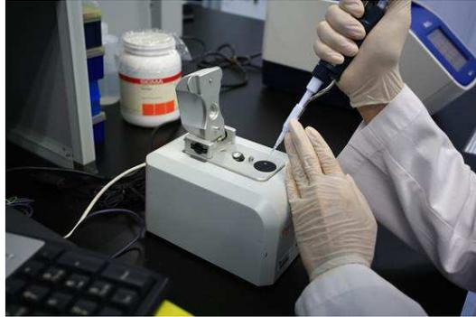
Figura 4.2.2.1: Equipo espectrofotométrico NanoDrop 2000c UV-Vis de THERMO SCIENTIFIC.
