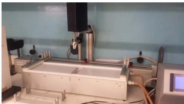
*Figura 21. Equipo KSV 5000 LB Langmuir Blodgett System equipado con una placa Wilhelmy*
