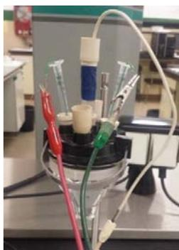
Figura 12. Celda electroquímica con 3 electrodos
