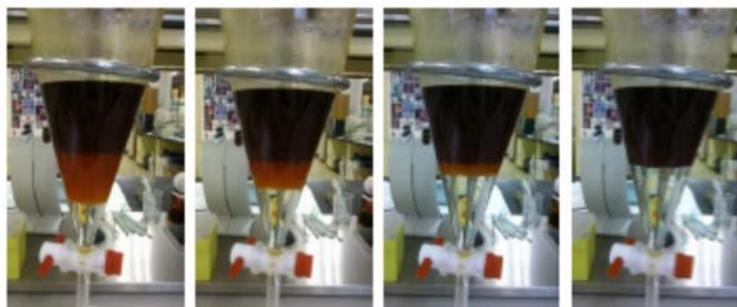
Figura 17. Transferencia de fase de los aniones  $\text{AuCl}_4^-$  de la fase acuosa a la fase orgánica.
