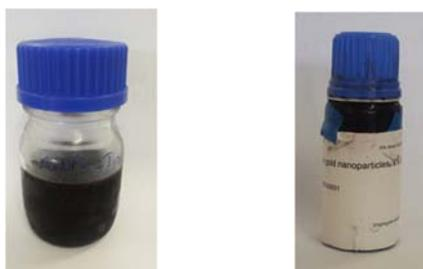
*Figura 25: A la izquierda, AuNPs funcionalizadas con dodecanotiol en cloroformo (sintetizadas) y a la derecha, AuNPs funcionalizadas con dodecanotiol en tolueno (comerciales)*
