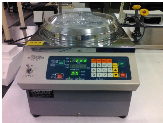
Fig. 15. a) (imagen izquierda), fotografía del spincoater usado para la deposición de la película. b) (imagen derecha), rotor del spincoater visto desde arriba.
