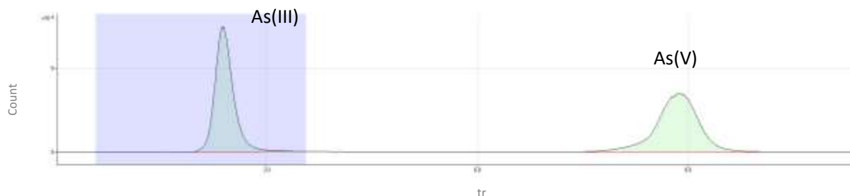
Fig. 3.4. Cromatograma correspondiente a un patrón de As (III) y As(V) ( t_R : 2,3 min y 8,9 min, respectivamente) analizado por HPLC-ICP-MS.
