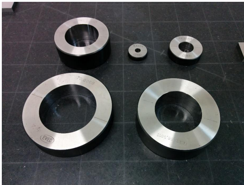
Figura 6.2: Juego de anillos patrón de diámetro interior.
