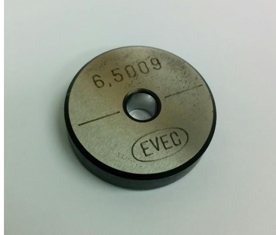
Figura 6.3: Anillo patrón de diámetro interior.
