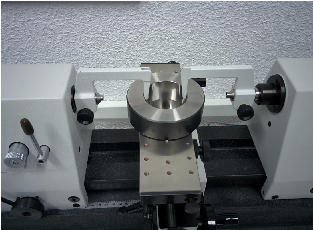
Figura 7.1: Medidora de 1 Coordenada Horizontal realizando el palpado de un patrón de diámetro interior.
