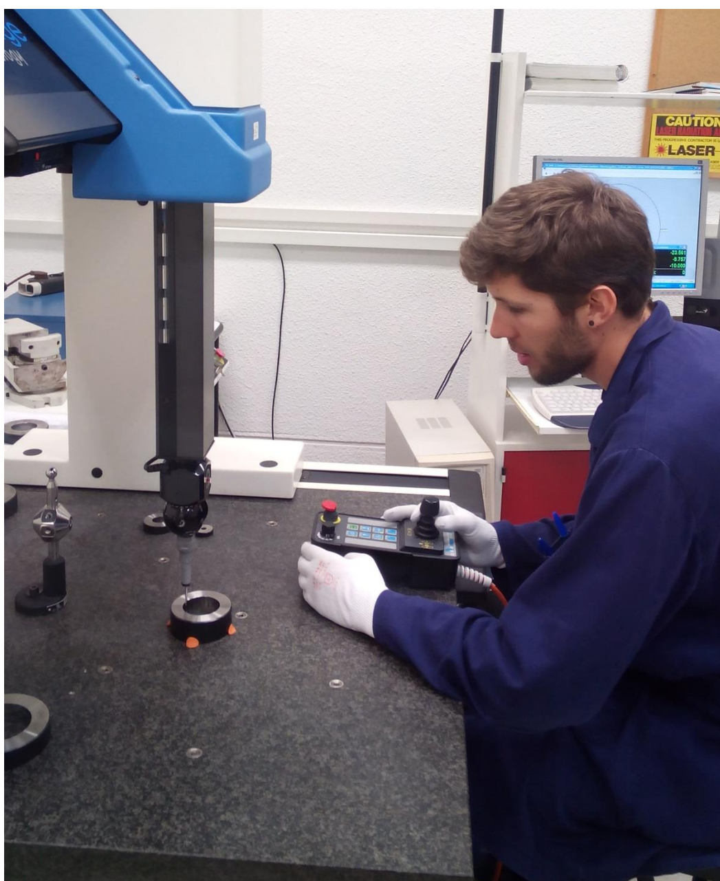
Figura 7.4: Medición de un anillo patrón de diámetro interior.
