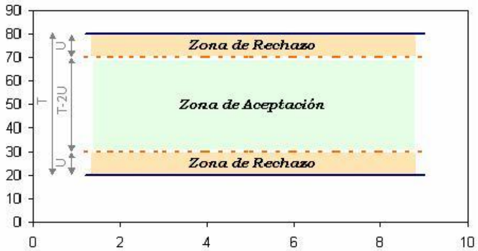
Figura 3.7: Criterio de seguridad que se utiliza en la práctica metroológica. (Carro de V. P. J, 2003)
