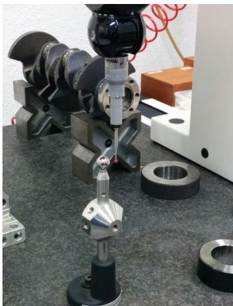
Figura 7.2: Determinación de la constante del palpador de MMC.
