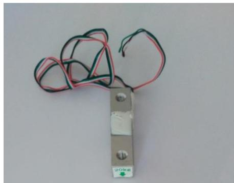
Figura 39. Célula de carga de 20 kg
