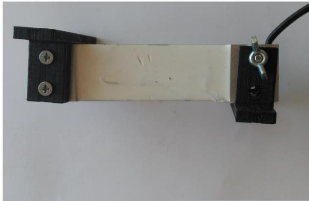
**Figura 21. Vista lateral de la unión de la célula de carga a los dos soportes**
