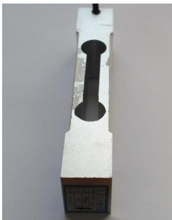
Figura 40. Célula de carga de 10 kg
