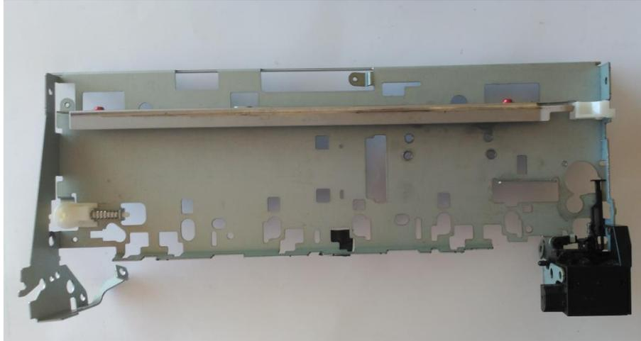
**Figura 11. Bancada del carro de impresora**
