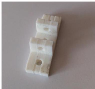
**Figura 34. Soporte para la célula de 20 kg**
