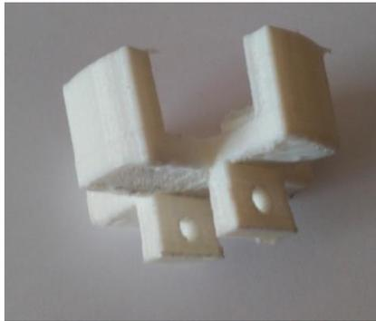
**Figura 33. Soporte para el motor**
