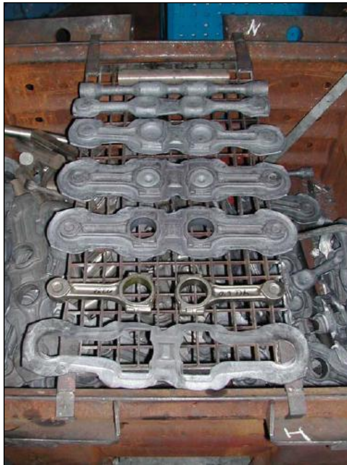
Imagen 7. Gama de forja para biela.
