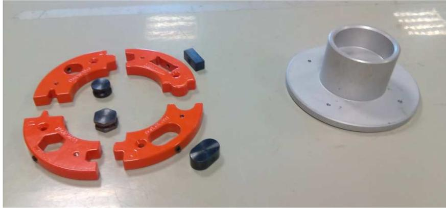
Figura 5.58: Base y capa de solectrón despiezado (Escuela Lean, 2014)
