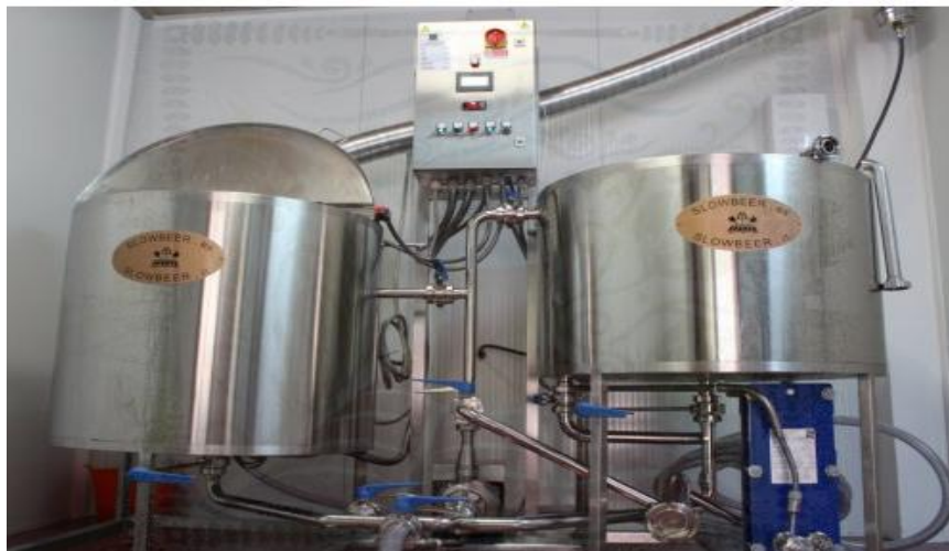
imagen 6: equipo para la elaboración del mosto
