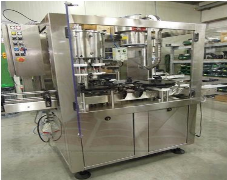
imagen 11: monobloque embotelladora y chapadora
