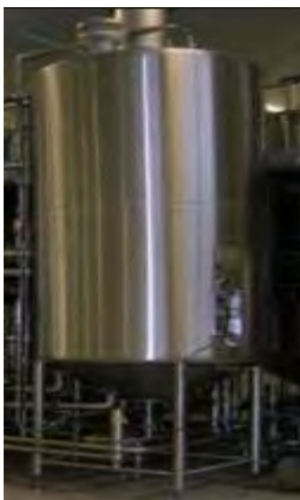
Imagen 21. Ejemplo de depósito madurador.
