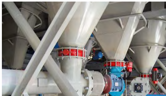
Imagen 17. Ejemplo de sistema de pesado, dosificación y transporte conjunto por tornillo sin fin.
