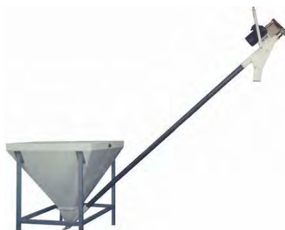
Imagen 16. Ejemplo de sistema de transporte de los sólidos al premezclador.
