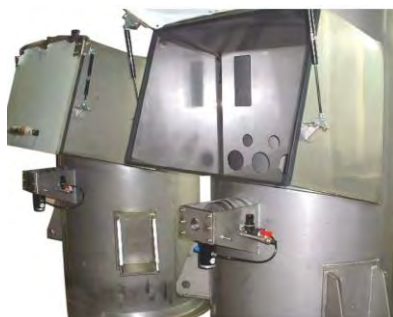
Imagen 18. Ejemplo de depósitos de almacenaje que estarían anexionados a los sistemas de pesado, dosificación y transporte conjunto por tornillo sin fin de la imagen anterior.
