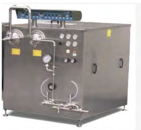
Imagen 22. Ejemplo de un equipo mantecador en continuo.
