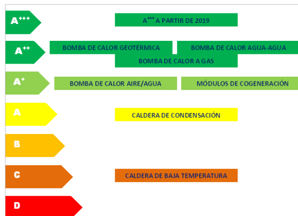
Fig. 3.62. Etiquetado energético de calderas
