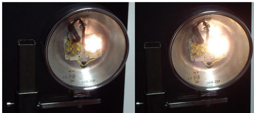
**Figura 4.-** Distintas modalidades de deslumbramiento que simulan la luminancia que caracteriza a unos faros halógenos (izquierda) y faros xenón (derecha).
