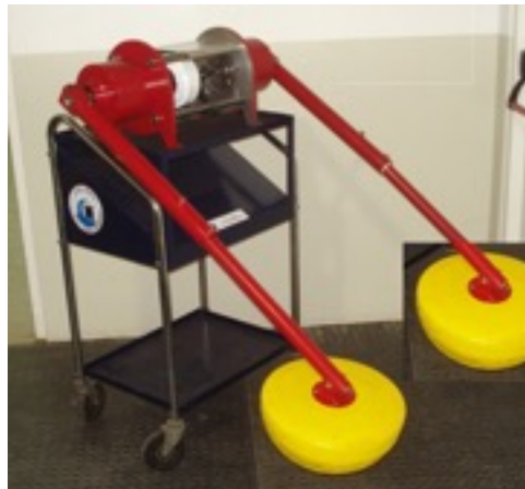
Figura 4: Prototipo undimotriz, escala 1:10, Argentina.
