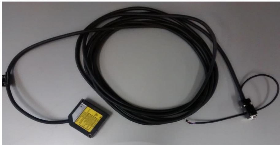
Figura 32: Sensor de desplazamiento láser utilizado en el registro de datos.
