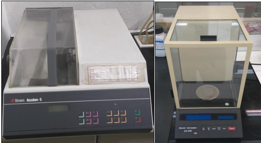
***Figura 3.2: Tronzadora de precisión metalográfica y báscula***
