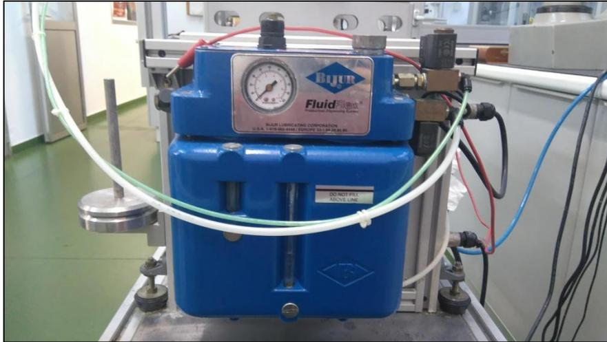
***Figura 3.7: Depósito de lubricante tribómetro***
