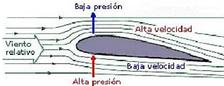
Figura 1.5: Representación del Intradós y el Extradós de un perfil aerodinámico [DPACOLOMBIA]
