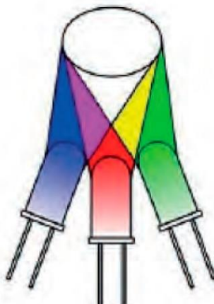
Figura 33. Mezcla aditiva de colores. Fuente: Guía sobre tecnología LED en el alumbrado
