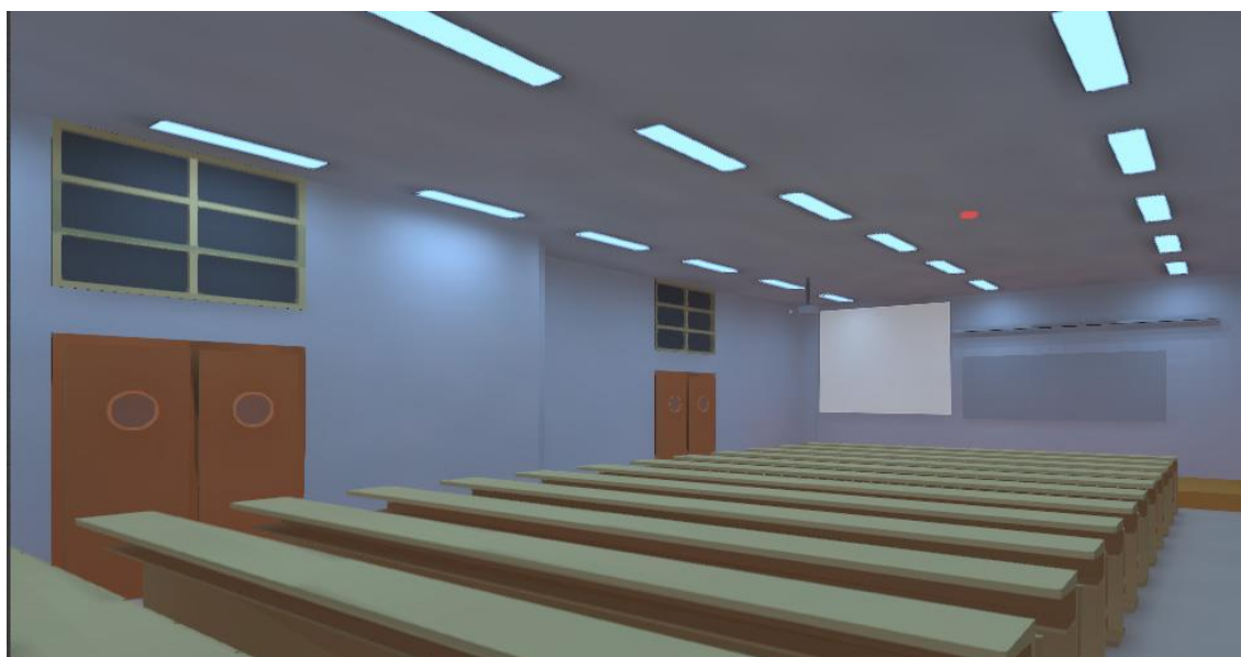
Figura 139. Simulación de niveles de iluminación para la visualización del proyector para la cuarta estrategia. Fuente: Elaboración propia
