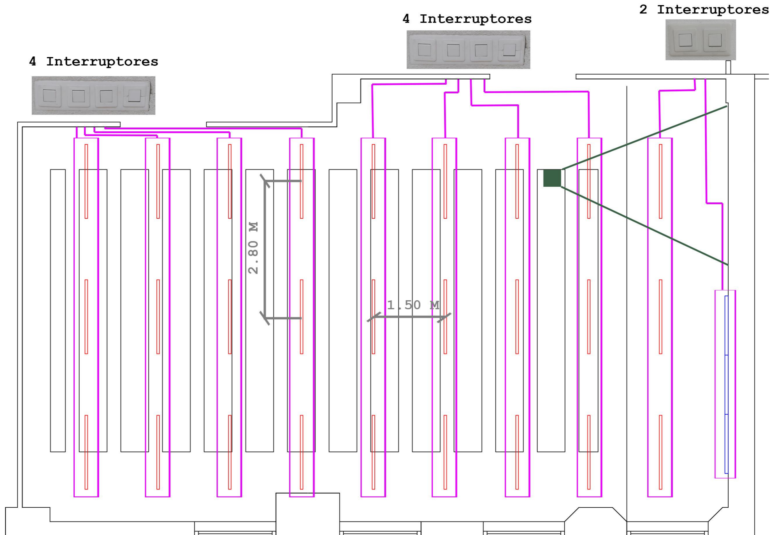
Figura 56. Grupos de luminarias, posición e interruptores de las aulas modelo en el estado inicial. Fuente: Elaboración propia
