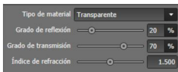
Figura 64. Reflexión y transmisión de los vidrios que conforman las ventanas de las aulas. Fuente: Elaboración propia
