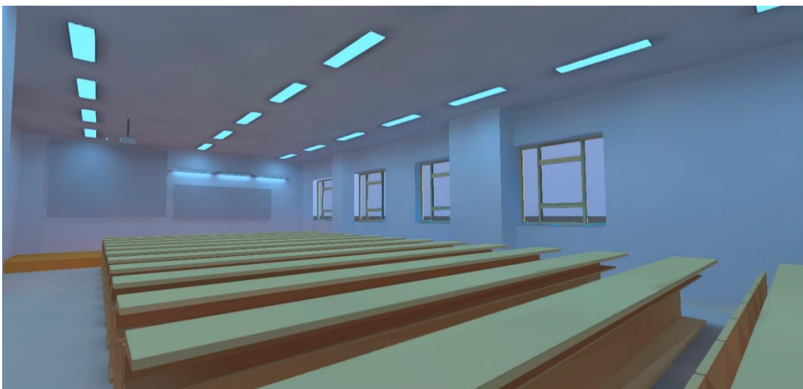
Figura 126. Perspectiva 1 del modelo de aula con luminarias LED empotrables con difusor para la cuarta estrategia. Fuente: Elaboración propia
