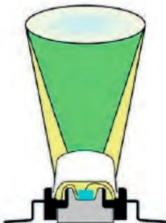
Figura 34. Chip azul + Fósforo amarillo. Fuente: Guía sobre tecnología LED en el alumbrado
