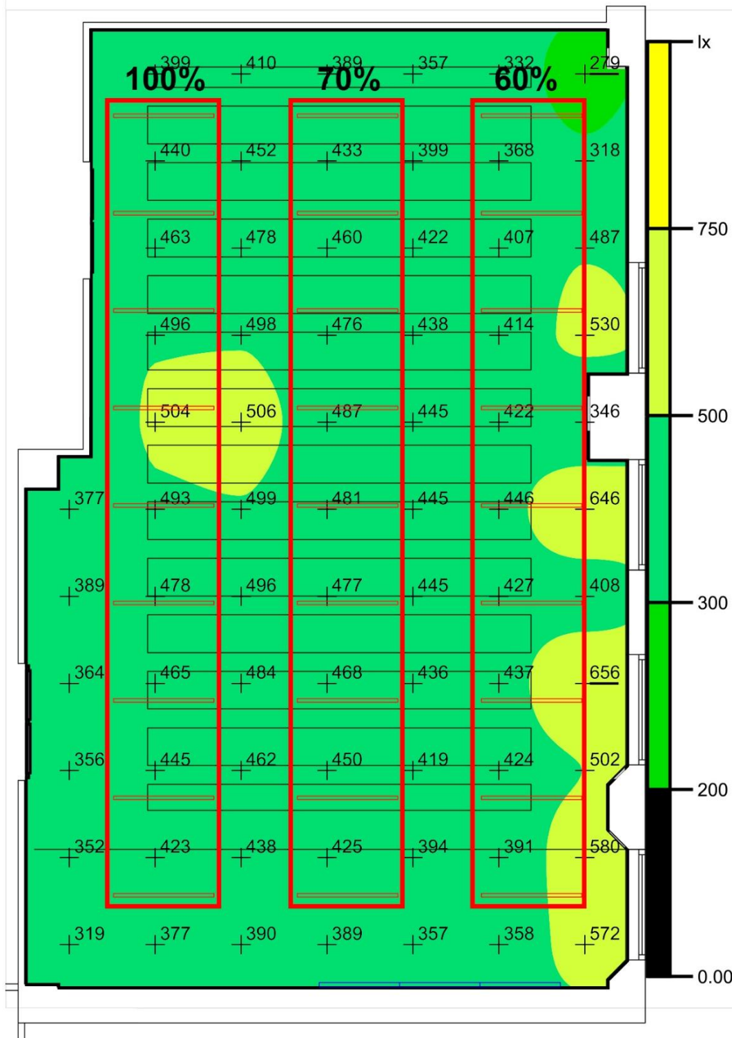
Figura 119. Intensidad lumínica horizontal para la simulación de horario de mañana en invierno con cielo cubierto en el caso 2. Fuente: Elaboración propia
