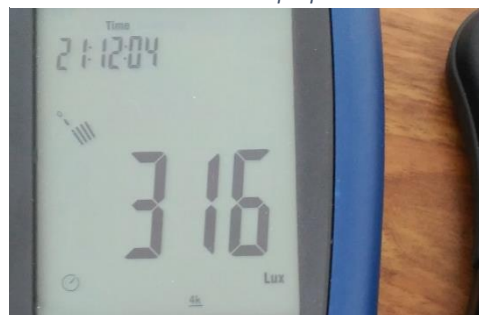
Figura 14. Escala de medición 4.000 lx. Fuente: Elaboración propia
