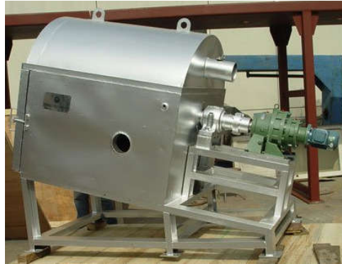
Figura 6.4 Horno de recuperación de zinc.
