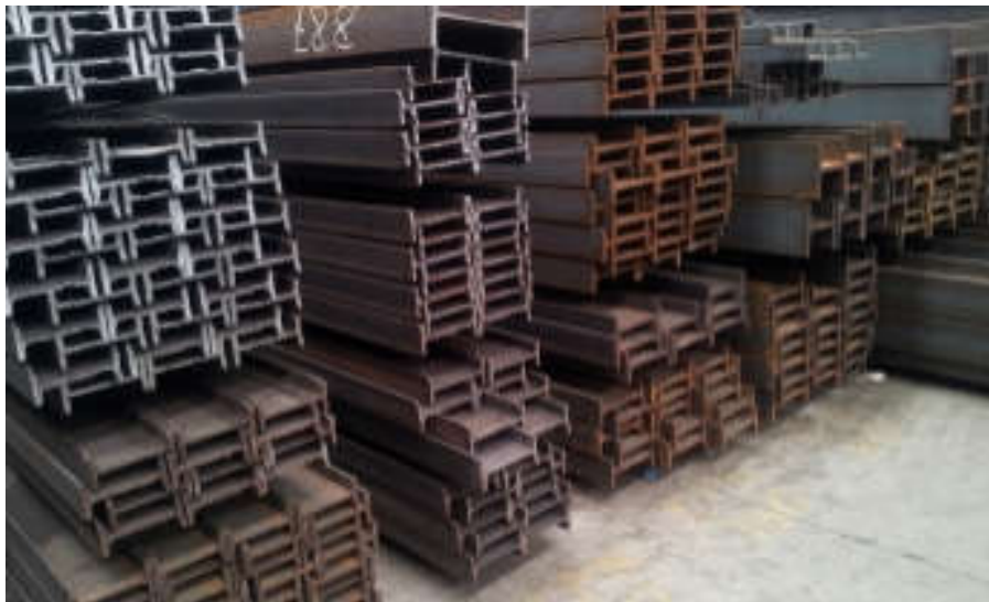
Figura 7.1 Almacén de material en negro.
