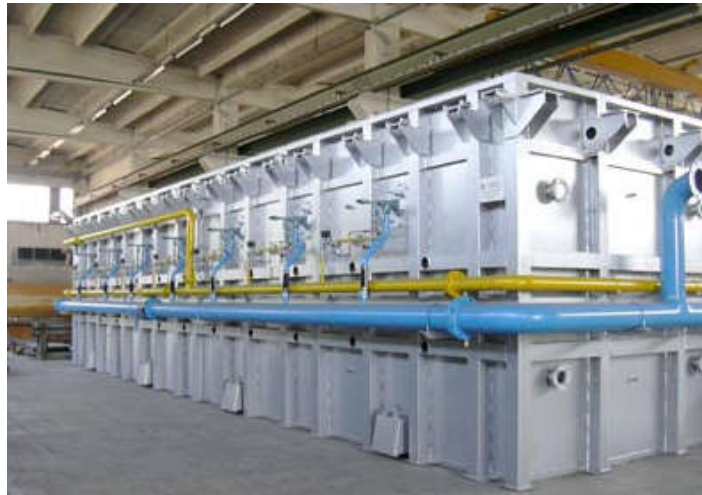
Figura 6.1 Horno de zinc fundido.
