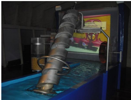
Figura 4: “Tornillo de Arquímedes”.(PLANTA SÓTANO: Zona del agua).
