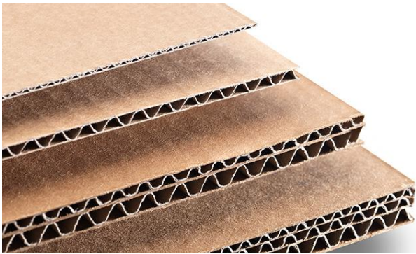
Imagen 21. Planchas de cartón como las empleadas para la construcción del recuperador de calor.
