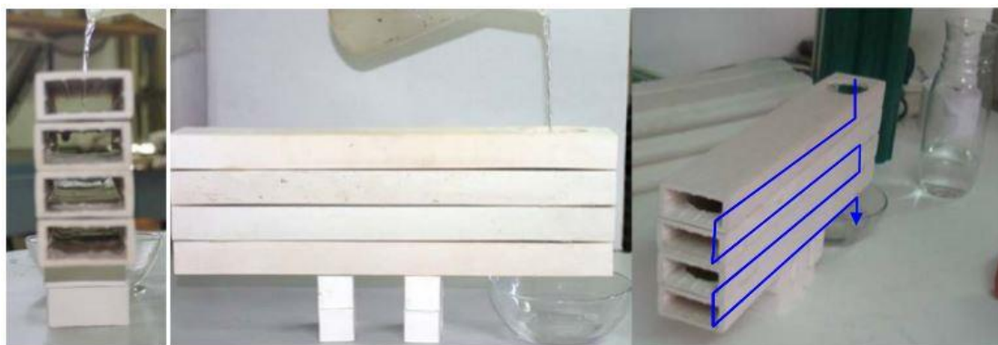
Imagen 18. Pruebas en laboratorio del funcionamiento del botijo.
