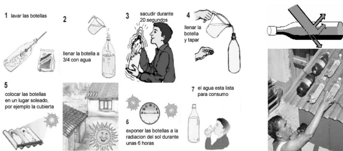
Figura 159: Desinfección solar de agua con botellas.
