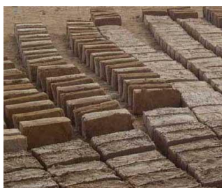
Figura 58: Adobes secándose al aire.
