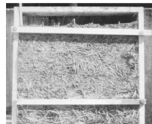
Figura 60: Asentamiento de un elemento de ensayo de barro alivianado con paja.
