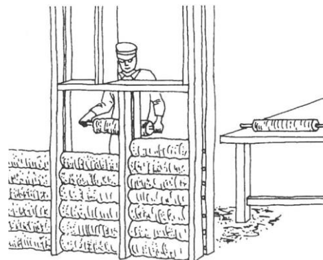
Figura 105: Entramado de madera con relleno de rollos de barro y paja "Wickelstaken".
