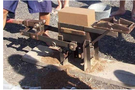
Figura 81: Bloque de suelo o BTC (bloque de tierra compactada). Prensa manual.
