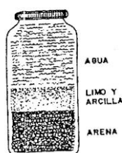
Figura 66: Prueba de la botella: agitar y dejar reposar.
