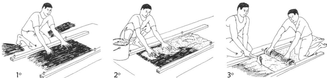
Figura 106: Elaboración de los rollos de paja y barro "Wickelstaken"
