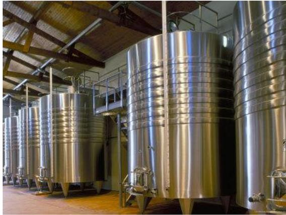
*Fig.1 Tanques de fermentación con camisa de refrigeración*
