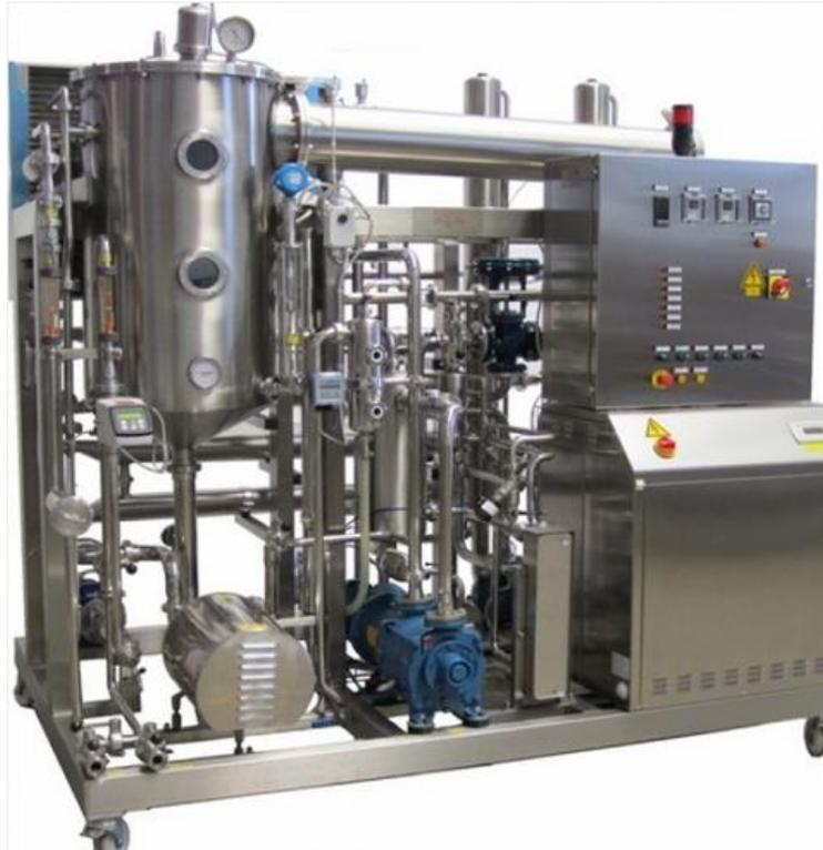
*Fig.9 Desalcoholizador REDA. Destilación en frío.*
