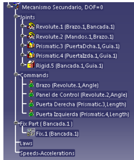
Fig. 8.9: Árbol mecanismo secundario
