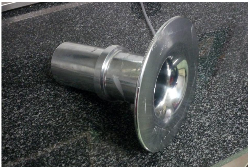
Figura A.4 Tobera convergente calibrada.
