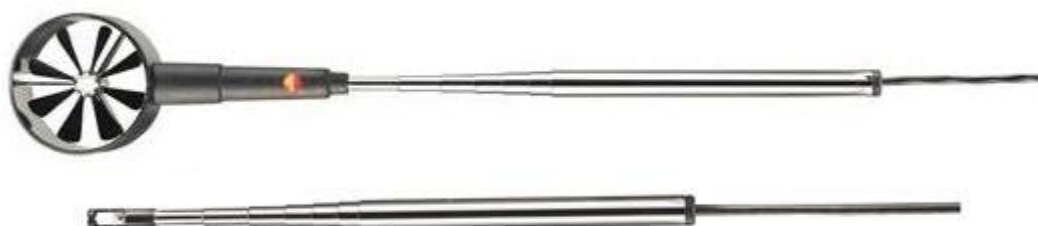
Figura A.5 Módulos de medición de velocidad, de rodete (arriba), de hilo caliente (abajo). [W-4]
