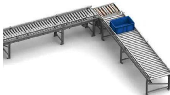
*Figura 4.29- Transportador para cajas con módulo de cruce*
