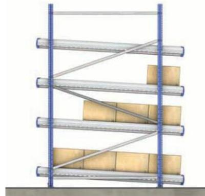
*Figura 4.42- Perfil de estantería de picking dinámico*
