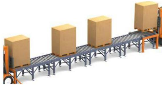
*Figura 4.20- Transportador para paletas en línea recta*
