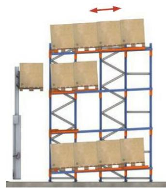
Figura 4.9- Perfil de estantería de paletización push-back
