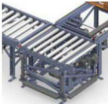
*Figura 4.22- Transportador para paletas con transportador mixto*
