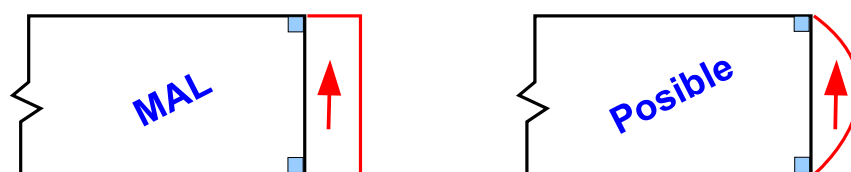
Figura 2.7: Hipótesis que violaría el principio de reciprocidad en las esquinas de una placa (a la izda.), e hipótesis aceptable (dcha.)
