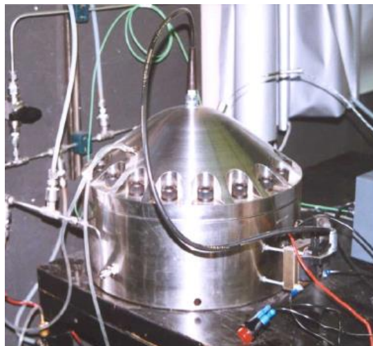
Figura 5. Bomba de combustión a volumen constante [Lafuente, 2008].
