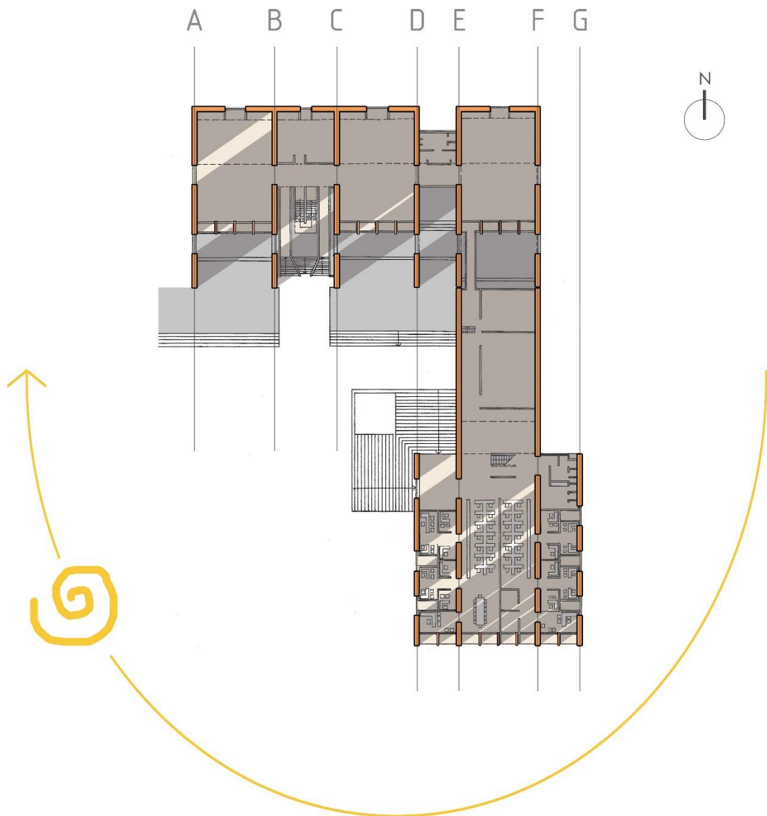
Ilustración 77: Escuela de Arquitectura (CEPT) – Planta primera. Modulación de los muros de fábrica portantes y de las aperturas orientadas a Sur (en naranja) y espacios de sombra con Solo de tarde. Elaboración propia sobre la documentación original del proyecto.
