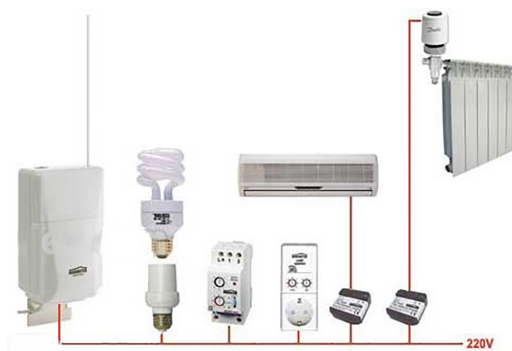
Fig 21. Esquema de instalación de cableado único, por un lado transcurre la instalación eléctrica y con ella la información de la instalación domótica.
