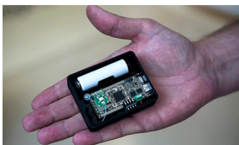
Fig. 44 Componentes de un nodo. Incluye la batería de alimentación, el microprocesador, los puertos para diferentes sensores y la antena de transmisión Zigbee
