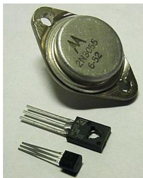
Fig. 14 (Izda) Diferentes tipos de transistores. Fig 14.1 (Dcha) Símbolo electrónico
