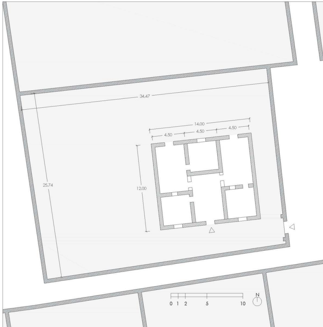
Imagen 37. Planta de la vivienda. Fuente: elaboración propia.
