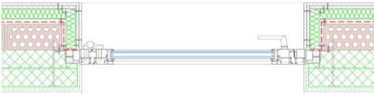
Instalación de carpintería en línea con el aislamiento. Elaboración propia.
