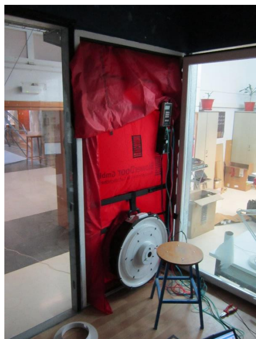
Ensayo Blowerdoor. Fotografía propia.
