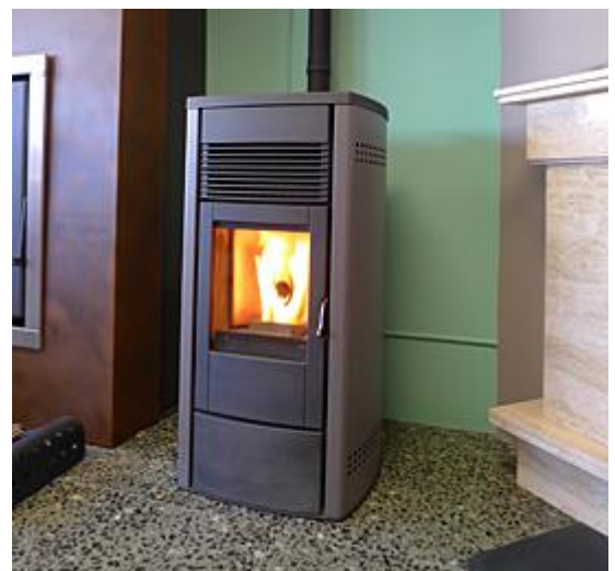
Chimenea estanca típica en una PSH. Fuente: chimeneas.agrupadasonix.com
