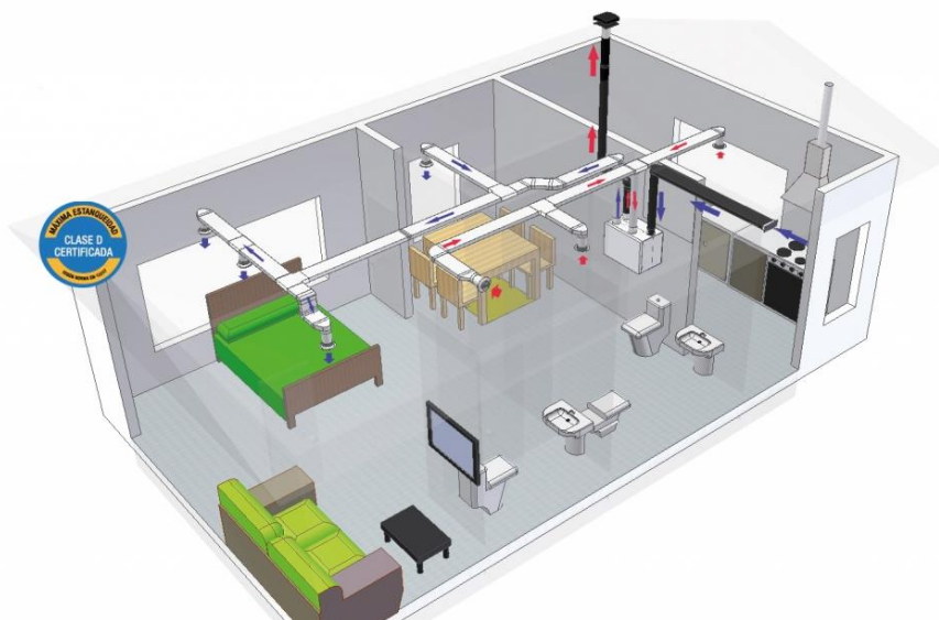
Sistema de ventilación de doble flujo. Fuente: pxsl.es
