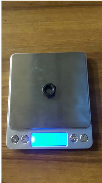
Figura 1.14: Medida del peso de cada tuerca a colocar sobre la estructura.
