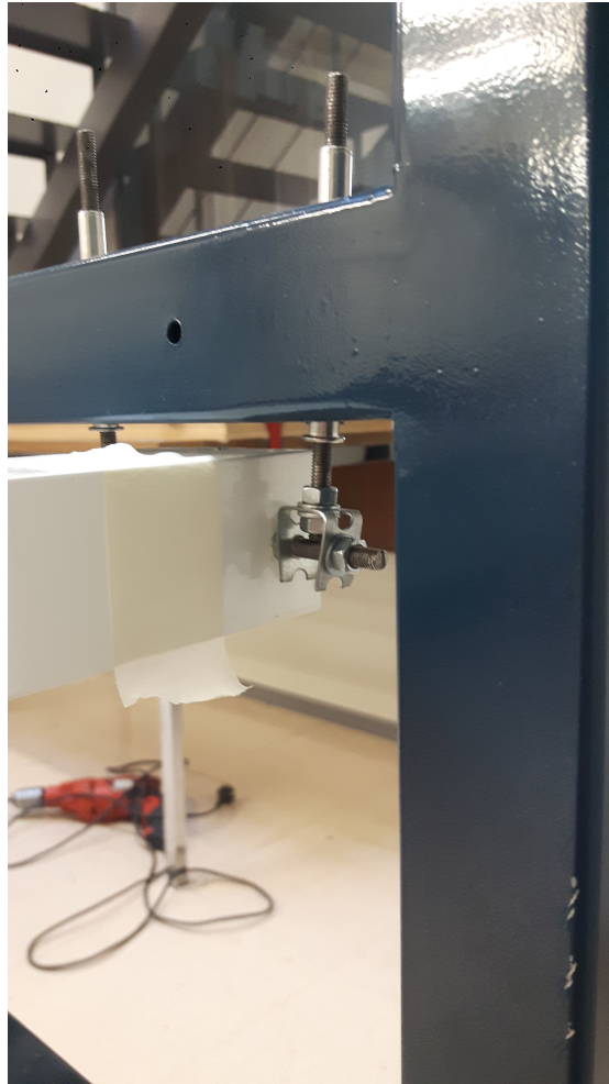
Figura 3.6: Apoyos sobre los que descansa la viga. Se observa que estos no permiten el desplazamiento en ninguno de los ejes, pero sí el giro.
