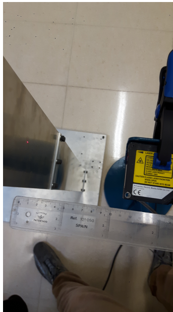
Figura 1.7: Colocación del sensor láser sobre peana mediante pinza.
