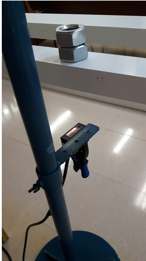
Figura 3.8: Disposición de masas puntuales sobre la viga y posición del sensor láser
