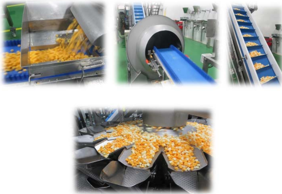
Fig. N° 21. Corte y dosificación de dados.
