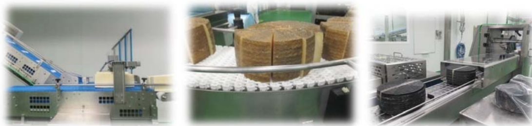
Fig. Nº 20. Corte y envasado de distintos formatos, (lonchas, cuñas, medios...)
