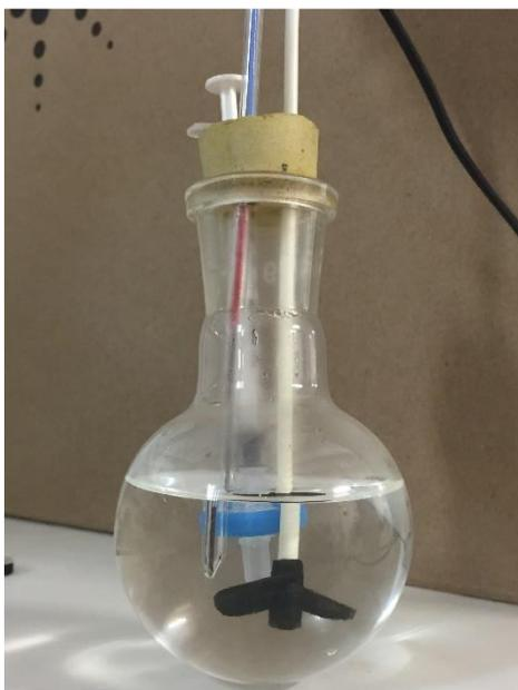
*Ilustración 4. Matraz de fondo redondo con agitador, jeringuilla y sonda.*
