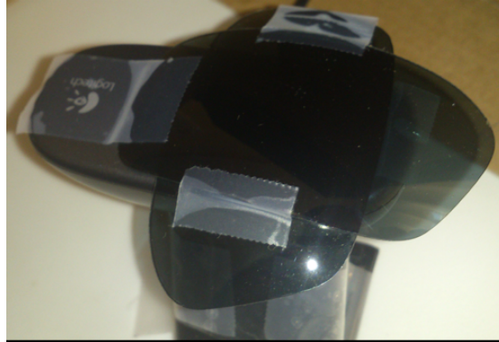
Figura 3.14: Cristales polarizados en la webcam para bloquear la luz visible.
