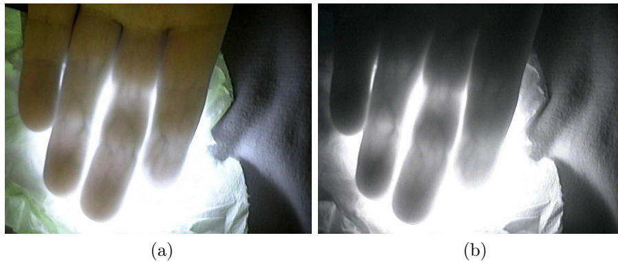
Figura 3.4: Prueba del método de transmisión de la luz en la captura de patrones vasculares del dorso de la mano.
