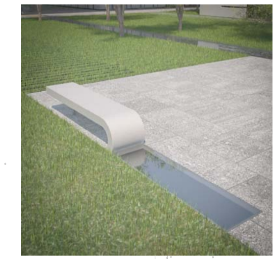
03. Bancos de hormigón prefabricado aligerado de alta resistencia EcoGranic y luminarias estancas integradas en el pavimento. Vista diurna y nocturna.
