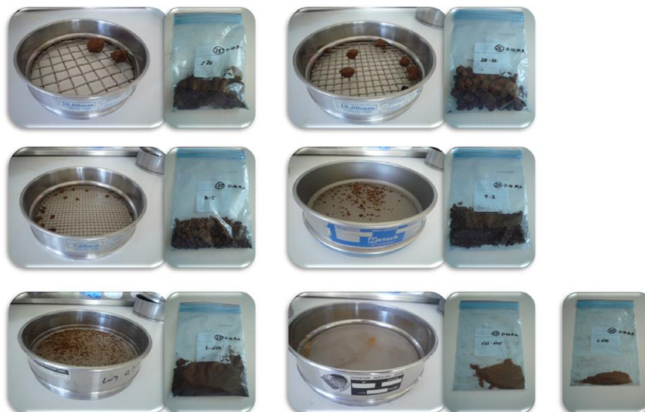
Figura 6.: Juego de tamices (20 mm, 10 mm, 5 mm, 2 mm, 0,25 mm, 0,05 mm) y tamaños de agregados separados en bolsas herméticas.
