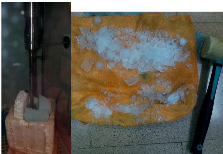
Figura 6: Equipo de ultrasonido Branson 450W Sonicator durante el proceso de sonicación de una de las muestras y hielo picado usado en el proceso.
