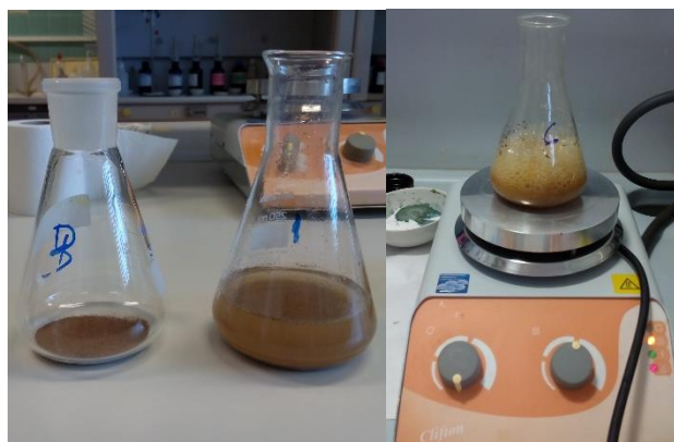
Figura 12: Suelo con 100 ml de ácido clorhídrico y posteriormente, hervido durante 5 minutos.
