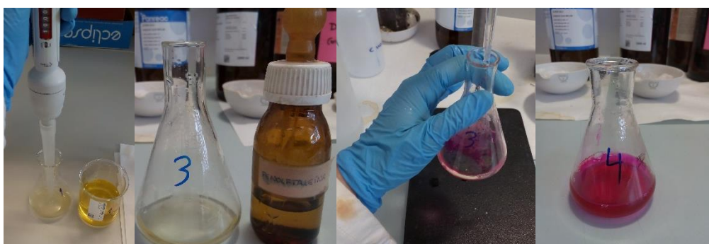
Figura 12: Procedimiento para la valoración de 10 ml del extracto filtrado, necesario para la determinación de los carbonatos totales.
