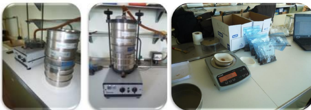
Figura 5.: Juego de tamices (20 mm, 10 mm, 5 mm, 2 mm, 0,25 mm, 0,05 mm y plato final), tamizador AS 2000 Digit de Reisch y proceso de pesado con balanza de precisión.
