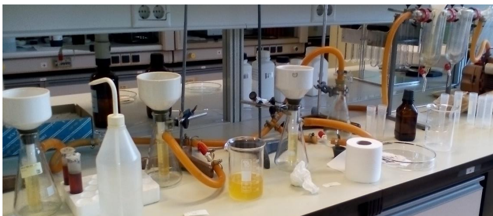
Figura 4: Montaje de filtrado a vacío (vacuum) por bomba
