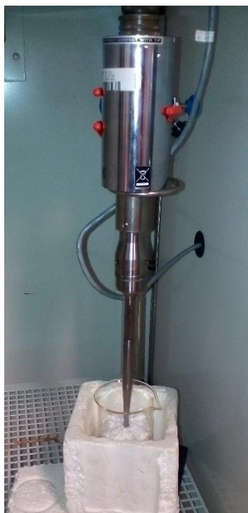
Figura 1: Equipo de ultrasonido Branson 450W Sonicator.
