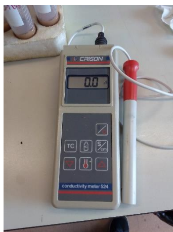
Figura 10: Conductímetro y termómetro para corregir la conductividad eléctrica.
