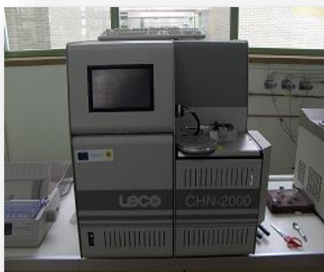
Figura 11: Preparación de las muestras para análisis de C y N total y analizador Leco CHN-2000.
