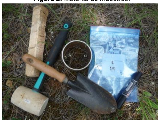
Figura 3: Proceso de recogida de muestras de hojarasca, horizonte orgánico y suelo.
