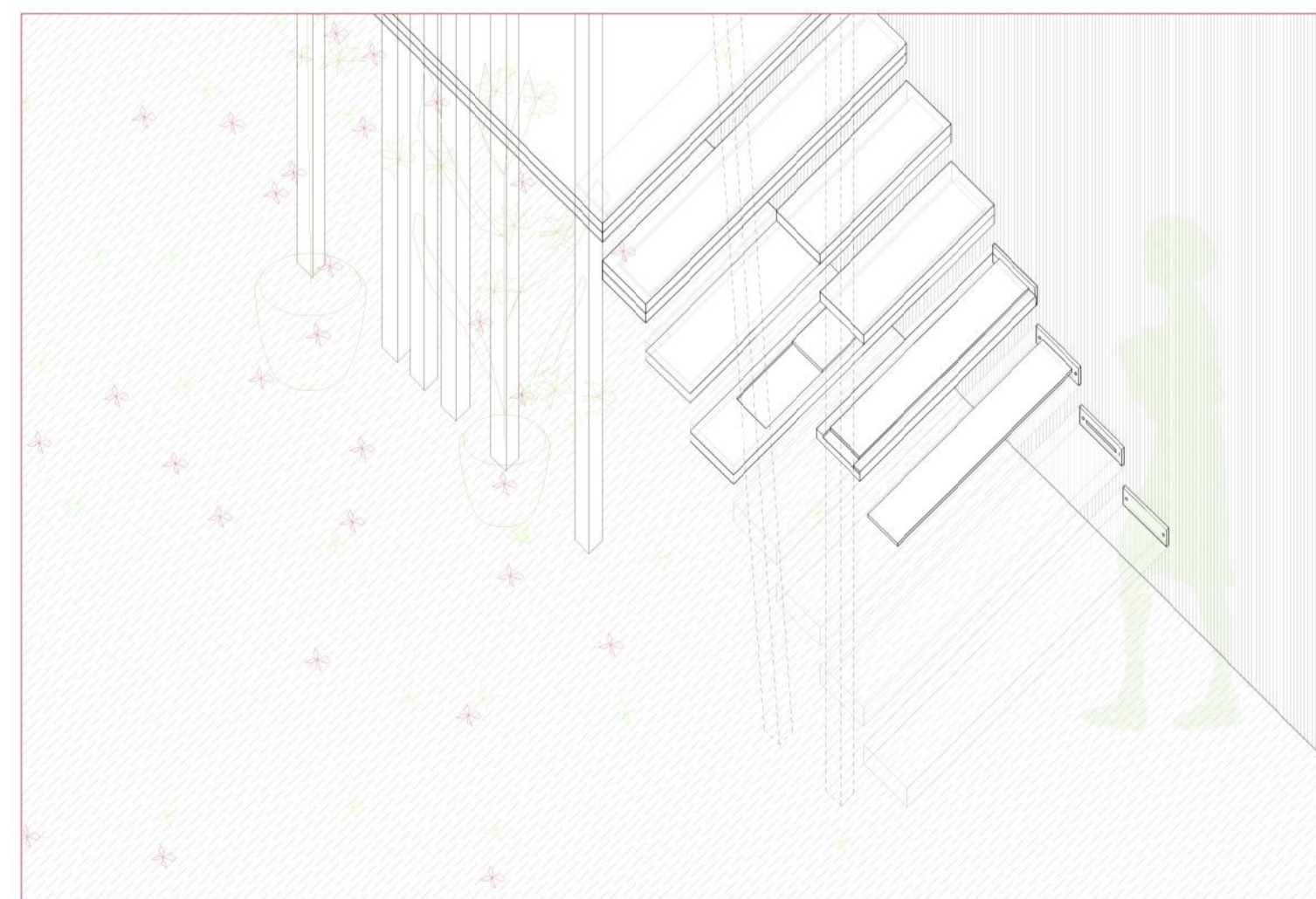
Axonometría escalera interior. Escala 1/30
