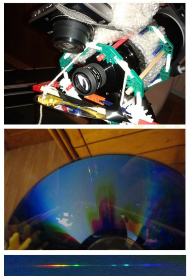
Fig. 1. Uno de los primeros prototipos de espectroscopio, con el que se logró obtener el espectro de una farola mediante un telescopio, un CD y una cámara compacta.
