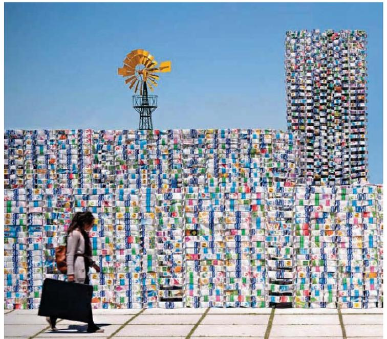
El ciclo del reciclaje se muestra capaz de generar una experiencia espacial concreta llevando al límite las posibilidades de un material constructivo tan singular como el tetrabrik. La construcción del pabellón explorará así cuestiones ligadas a una nueva fábrica resultado del cosido, apilamiento, yuxtaposición, trabado, etc., de un cartón de leche.
