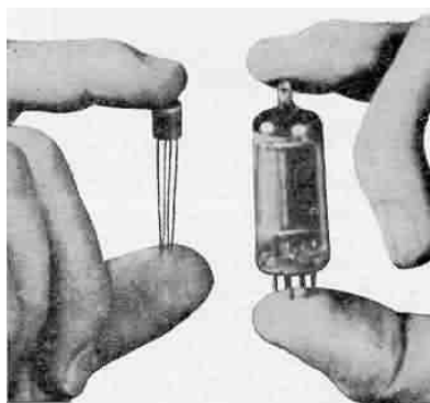
Fig. 5.1.2 Comparación de tamaño de transistor vs válvula
