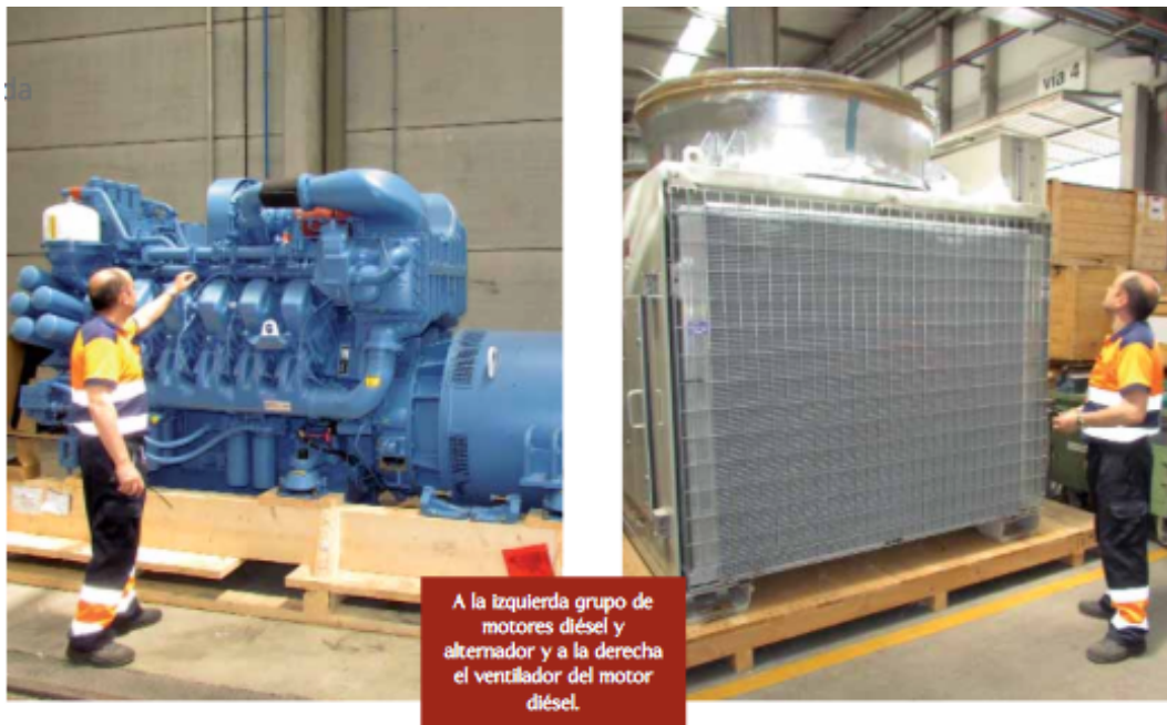
Fig. 6.1.3 Motor – alternador y radiadores de refrigeración RENFE Serie S – 730
