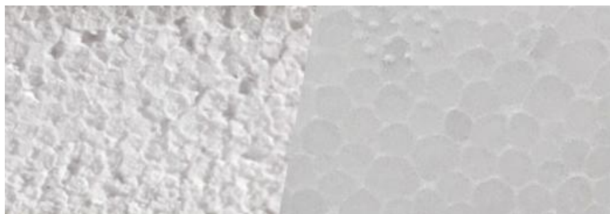
Img. 39: Diferencia no piel de espuma (mecanizado)/ piel de espuma (inyectado)
