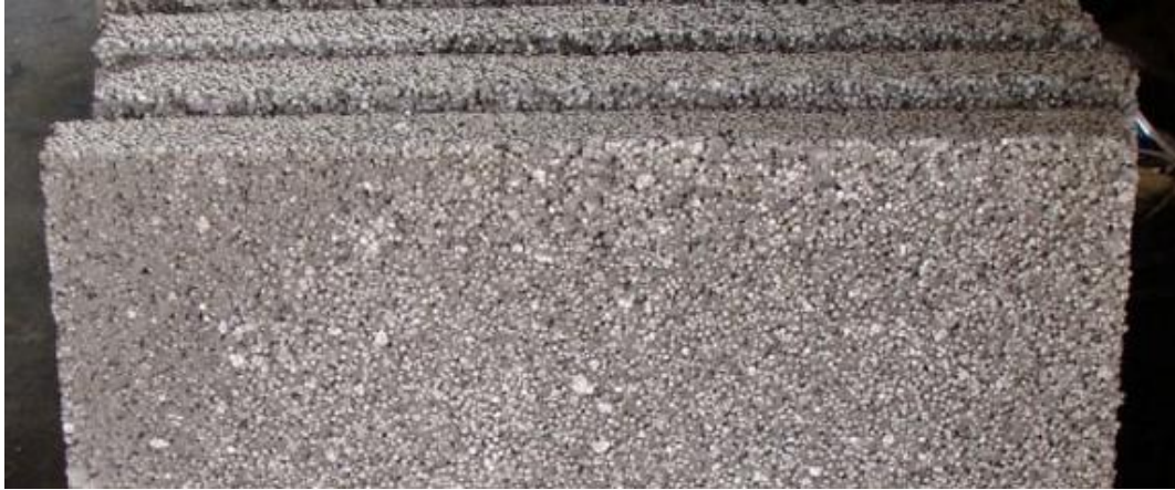
Img. 44: Hormigón liviano
