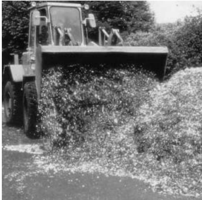
Img. 42. Mezcla de EPS con tierra para mejorar la aireación
