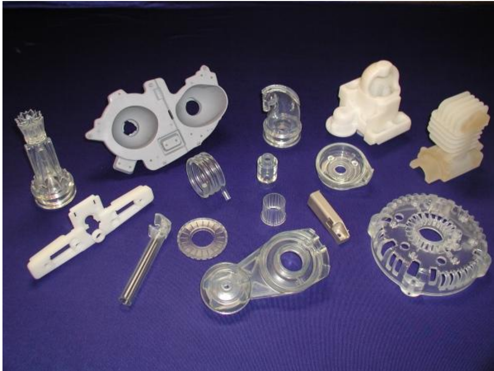
Img. 81. Piezas realizadas por prototipado rápido (estereolitografía y sinterizado láser selectivo)
