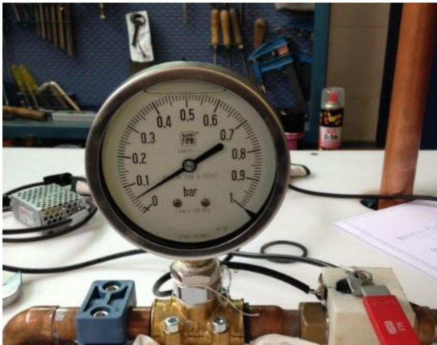
*Figura 4.16 Manómetro conectado en el collarín*
