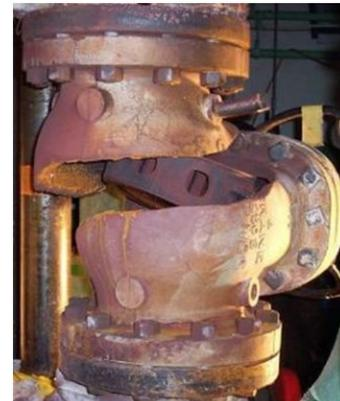
Figura 2.15 Válvula de hierro fundido dañada [T1]
