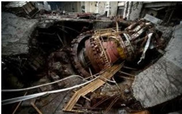
Figura 2.14 Ejemplo de turbina rota por golpe de ariete [T1]
