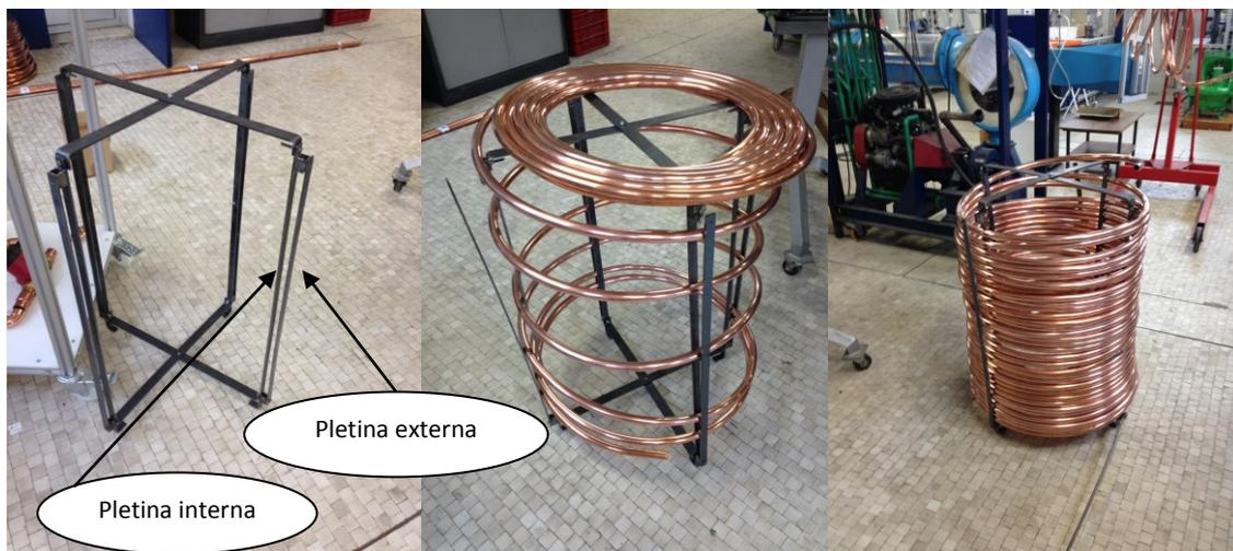
*Figura 4.10 Proceso de montaje del serpentín en la estructura formada por pletinas*
