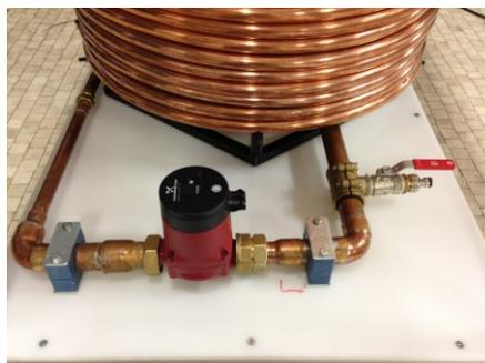
*Figura 4.12 Conexiones de la bomba*
