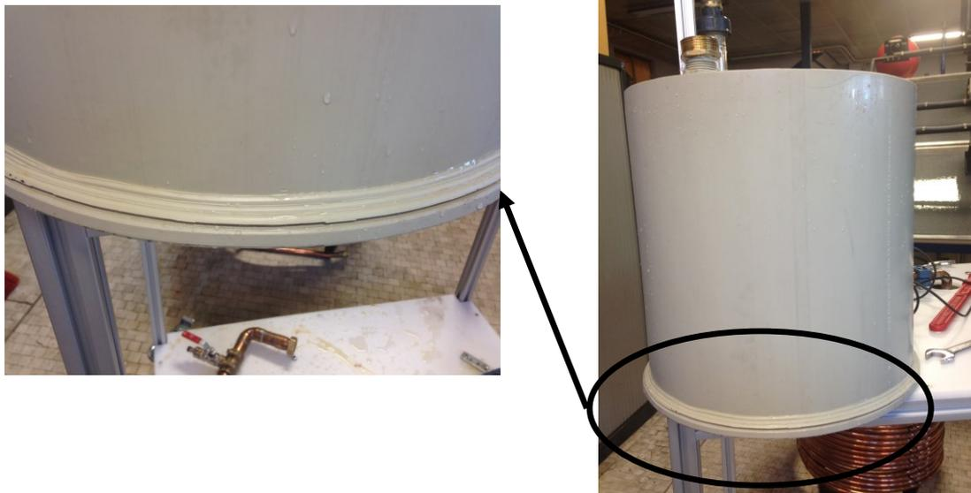
Figura 4.18 Rotura del depósito
