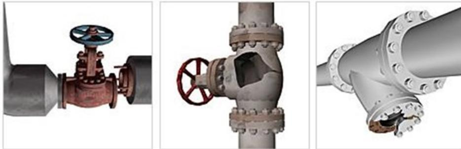
Figura 2.13 Ejemplos de tuberías dañadas por golpe de ariete [w1]
