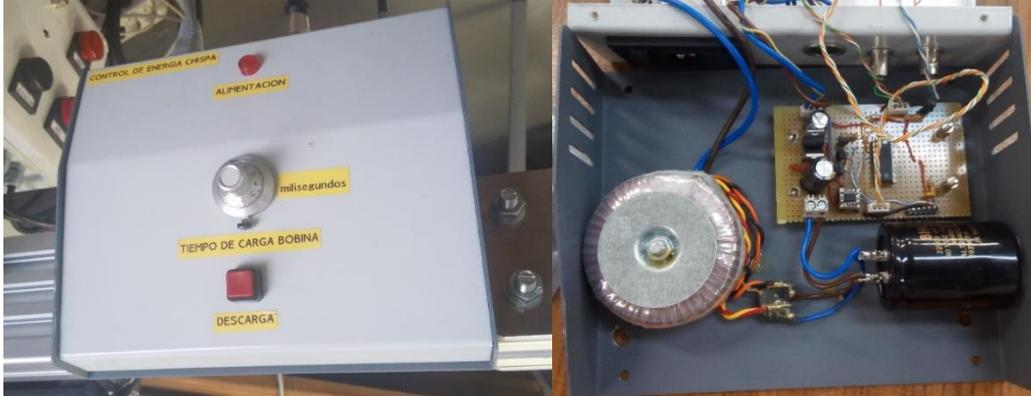
Figura 3.13 Sistema de encendido
