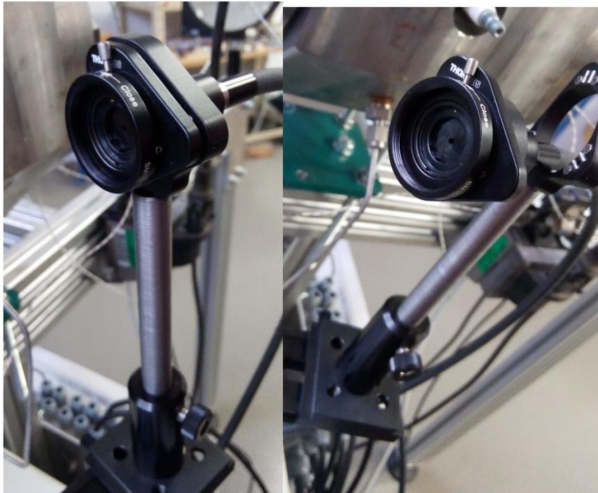
Figura 3.42 Adaptador de fibra óptica
