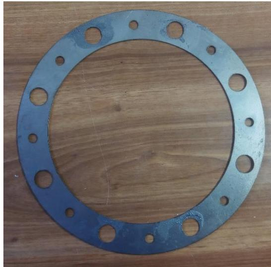
Figura 3.6. Juntas cámara de combustión
