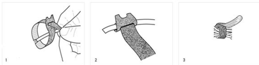
Figura 34: esquema de funcionamiento del sistema de agarre.
