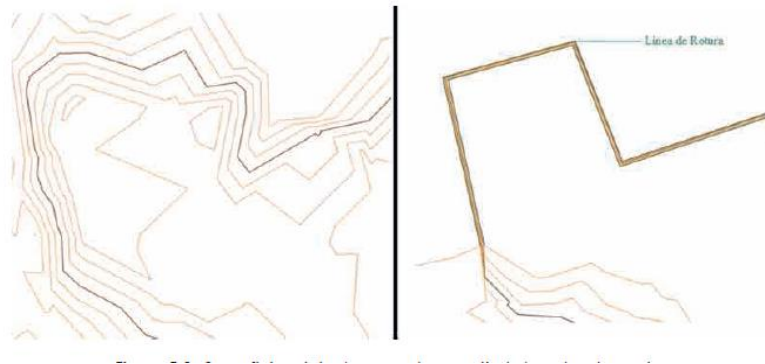
Figura 78, tratamiento con líneas de rotura.
