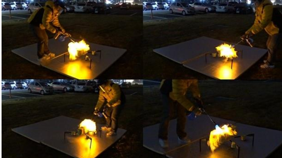
Figura 41, FAROS sometido a una prueba de resistencia al fuego.
