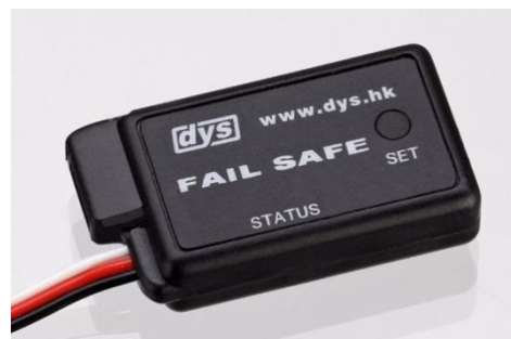
Figura 10, failsafe independiente a la controladora de vuelo.
