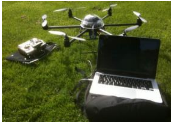
Figura 75, multirroto de 6 ejes con mando a distancia y un ordenador portátil para configurar el sistema GPS.
