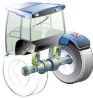
Ilustración 11. Sistema de suspensión de cabina “New Holland Comfort Ride”
