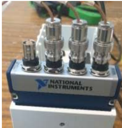
Ilustración 40. Conexión de los cables de los acelerómetros (3 ejes) con el módulo de serie C NI 9234
