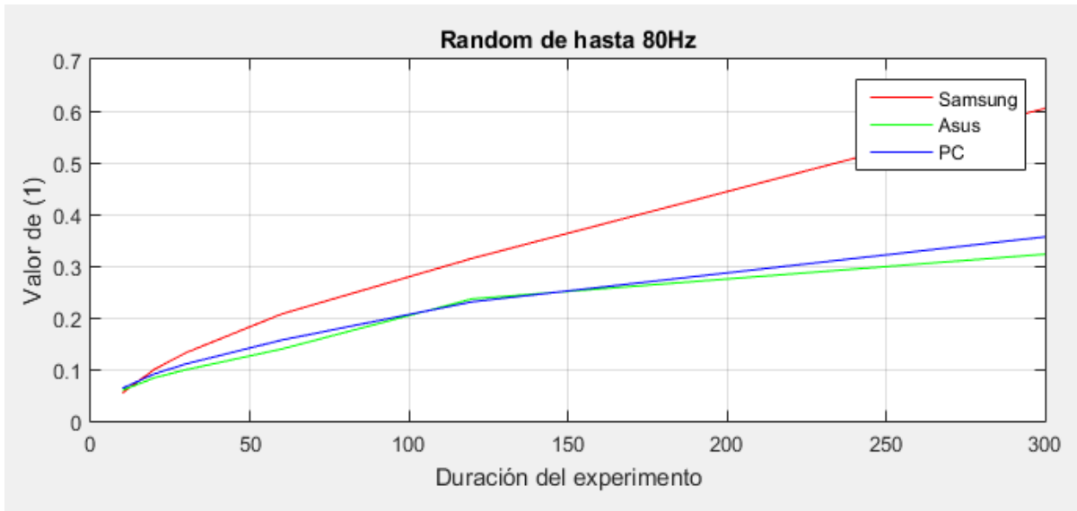
Ilustración 102. Comparación de los valores de aceleración en el experimento Random de entre 1Hz y 80 Hz
