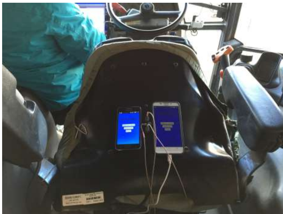
Ilustración 109. Colocación de los equipos de medida en la cabina del tractor
