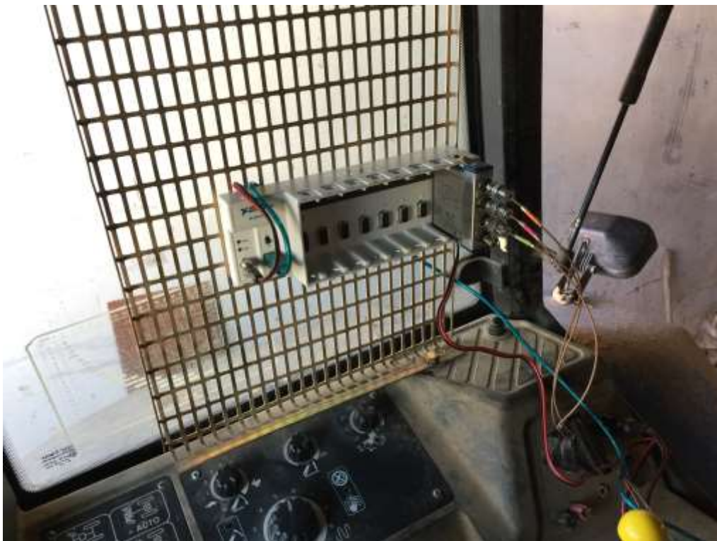
Ilustración 107. Instalación del sistema de adquisición de datos sobre el tractor
