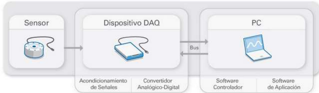
Ilustración 38. Estructura de un sistema DAQ
